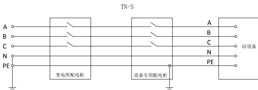
注：PE线除了在变电所配电柜处和N线相接以外，其他各分柜处均不得相连接。
